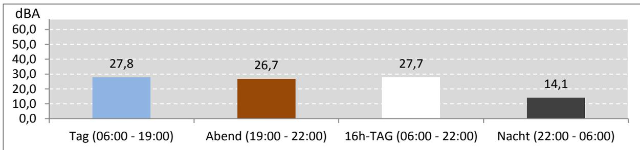
Abb. 8: LEQ bei Pistenbetriebsrichtung "Windstille" 96 Stunden im Messzeitraum
